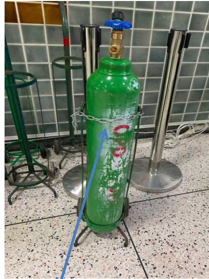
โซ่โซ่เกี่ยวเพื่อช่วยปรับเข้า-ออกได้ตามขนาดท่อ
